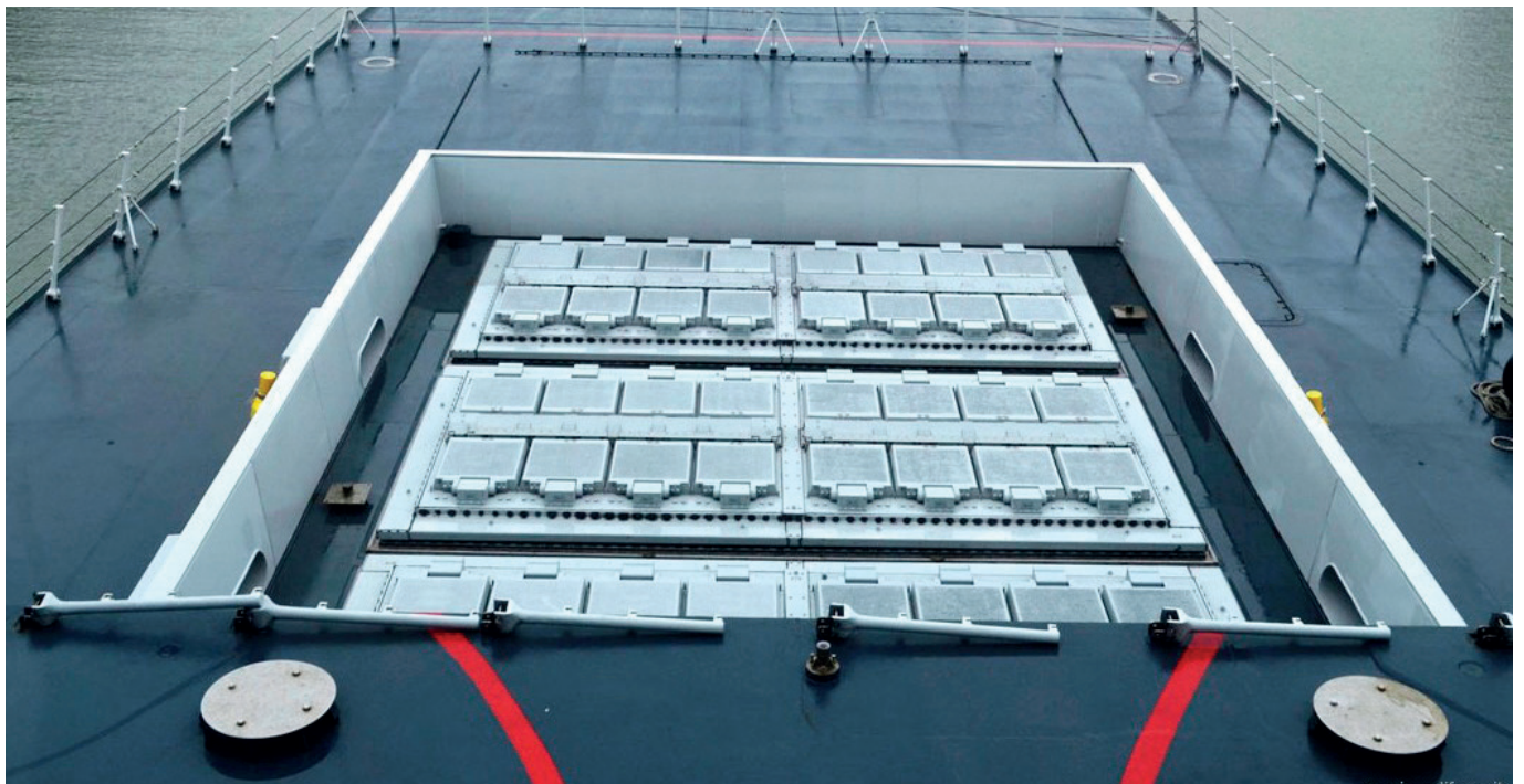
แท่นยิงจรวดนำวิถีต่อสู้อากาศยานไมกา (MICA) ระบบต่อสู้อากาศสำหรับป้องกันภัยทางอากาศให้กับเรือรบชนิดแท่นยิงทางดิ่ง (VLS, MICA) ระยะสูงปานกลาง
